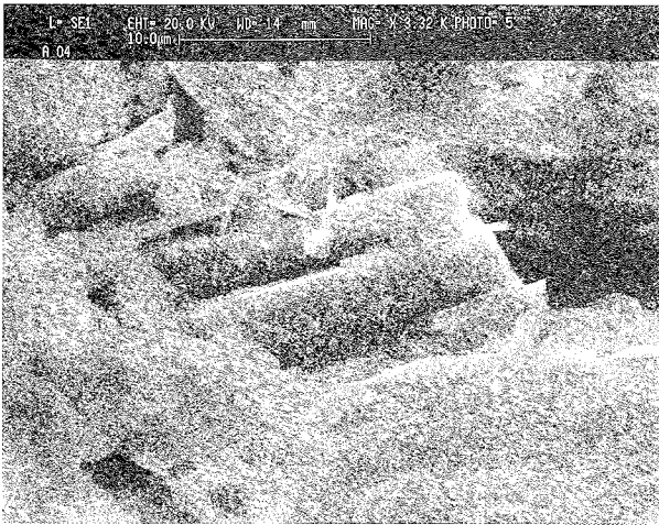
Fig. 21 - Visioni al SEM. Camp. B06. Cristalli prismatici di phillipsite, immersi in una matrice fillosilicatica.
