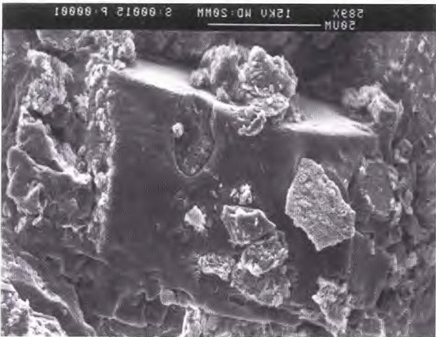
Fig. 16 - Microfoto al SEM (scanning electron microscopy), relativa a superficie resa a spacco di un campione di arenaria proveniente da un blocco di Palazzo Ducale (camp. D4) ove si evidenzia un cristallo di salgemma, di circa 80 µm, inglobante nuclei di particellato dell'originaria roccia clastica.
