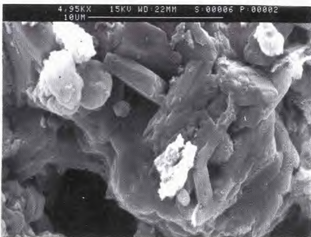
Fig. 17 - Microfoto al SEM (scanning electron microscopy). Si osserva una elevata macro e micro - porosità con presenza di cavità di "dissoluzione", che conferiscono al materiale l'aspetto vacuolare con conseguente abbassamento della coesione. Si ha l'aumento della superficie specifica e, di conseguenza, la progressiva alterazione delle parti più interne del materiale.
