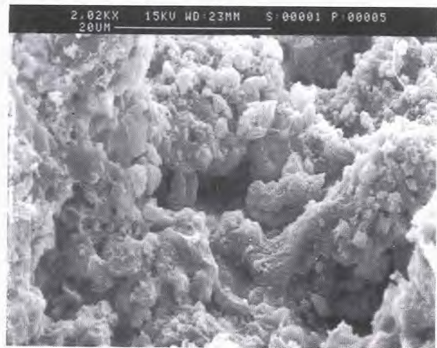
Fig. 12 - Microfoto al SEM (scanning electron microscopy). Nel materiale si delinea la presenza di cavità e fratture seguenti alcuni allineamenti; le cavità hanno dimensioni anche di 5 - 10 \mu\text{m} e sono comunicanti fra loro.
