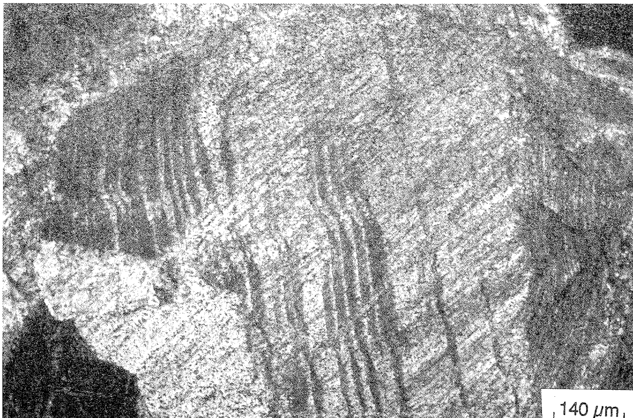
Fig. 8 - Microstrutture nelle calciti. Nicols incrociati. Le lamelle di geminazione si presentano ondulate.
