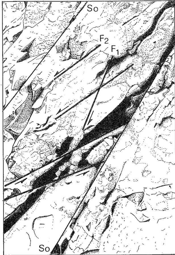
Fig.7b - La figura tratta dalla precedente evidenzia le strutture deformative in rapporto alle superfici di strato. L'intersezione tra i sistemi F1 e F2 coincide con la direzione di strato, mentre la bisettrice dell'angolo acuto tra gli stessi sistemi di faglie coincide con l'immersione di strato.
